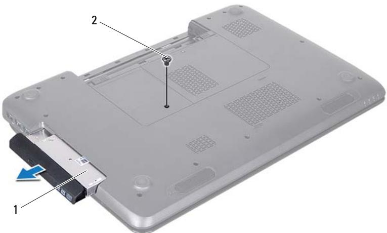
1 sklop optičkog pogona      2 vijak
